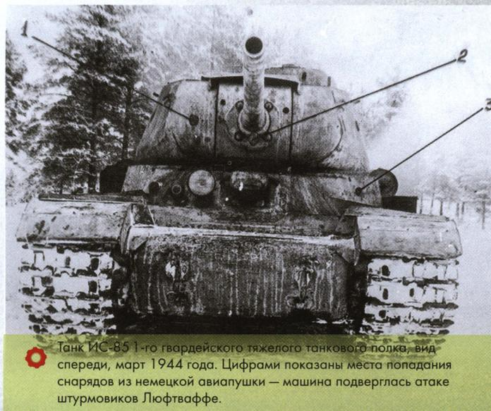
Танк ИС-85 1-го гвардейского тяжелого танкового полка, вид спереди, март 1944 года. Цифрами показаны места попадания снарядов из немецкой авиапушки — машина подверглась атаке штурмовиков Люфтваффе.
