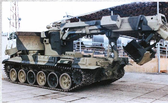
Инженерная машина разграждения ИМР-3, вид сзади. Рабочая стрела оснащена ковшем, который входит в комплектацию машины.
