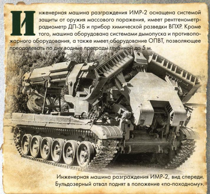
Инженерная машина разграждения ИМР-2, вид спереди. Бульдозерный отвал поднят в положение «по-походному».
