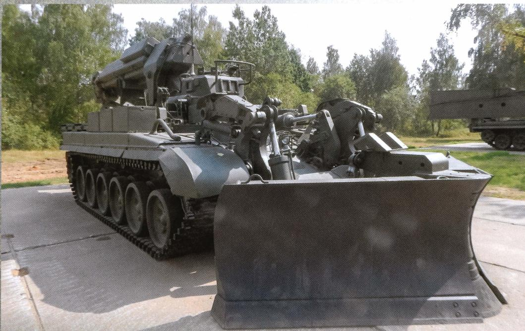
Инженерная машина разграждения ИМР-3М, общий вид. Бульдозерный отвал в рабочем положении.
