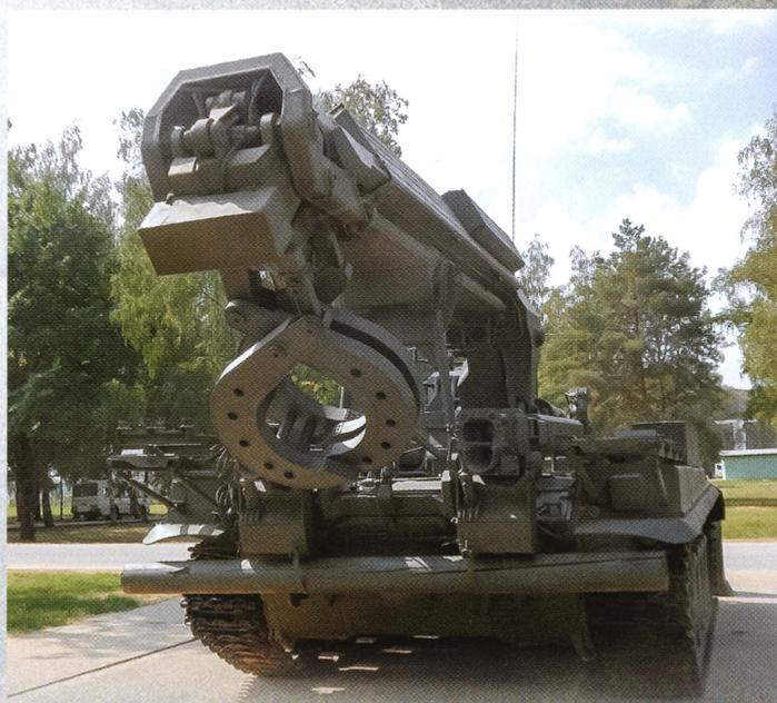
ИМР-3М, вид сзади. Хорошо видна конструкция манипулятора.
