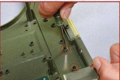
**9** Используя отвертку, не прилагая особых усилий, закрутите винты.
